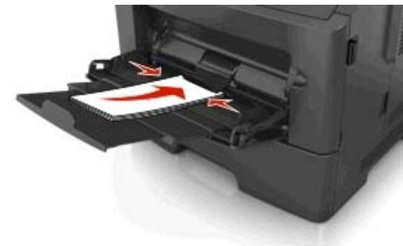
**警告！破損の恐れあり:** 切手、留め金、スナップ、窓、つや出し加工された内張り、封かん用口糊の付いた封筒は絶対に使用しないでください。このような封筒を使用すると、プリンタに深刻な損傷が生じる可能性があります。
